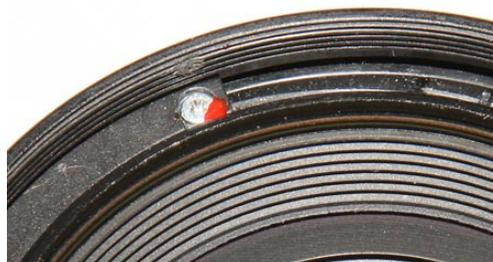
Re-clipser le cache vis en introduisant le picot dans le trou légèrement oblong en dernier.
