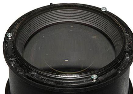
Banc de montage en position, a la distance de 3pieds ou 92cm de la mire, bague de mise au point manuelle alignée sur cette distance en focus manuel la lentille est donc positionnée sur ses rampes pour obtenir la netteté maximale et cette position repérée pour le montage définitif.
