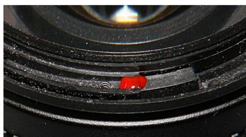
Remette en place rapidement la plaque de fixation pour que le vernis ne fasse épaisseur en respectant la position du détrompeur et resserrer les trois vis Parker la maintenant. Attention à serrer modérément le taraudage du corps de l'optique étant assez fragile. Sceller ces trois vis par une goutte de vernis.
